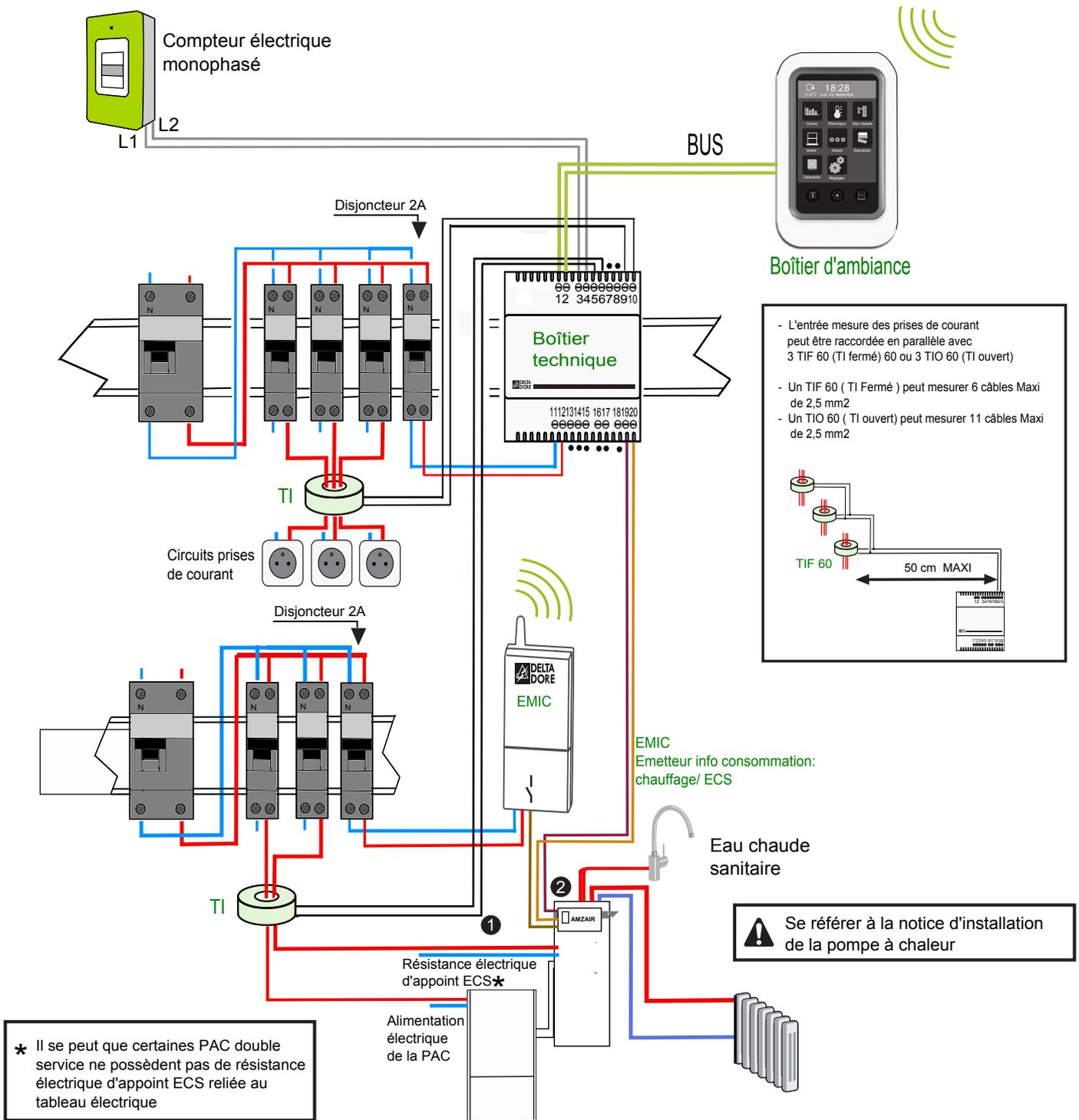
① Raccordement de l'EMIC sur le bornier 44 du coffret électrique de la PAC AMZAIR
