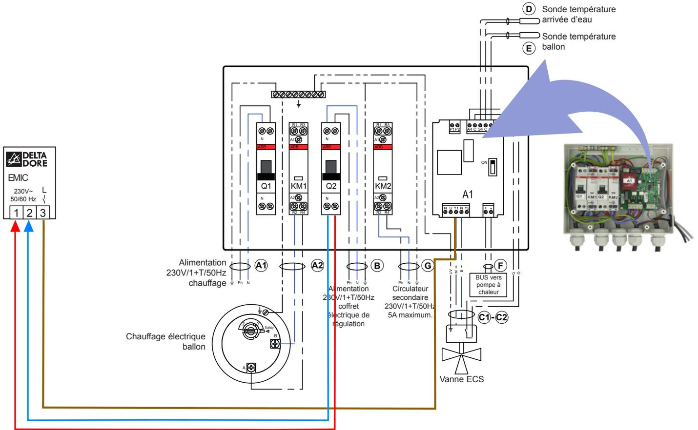
**Principe de fonctionnement de la Vanne 3 voies directionnelle SPDT**
