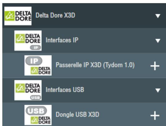
Il existe 2 connecteurs X3D disponibles, un connecteur USB (clé USB fourni avec le serveur) ou un connecteur IP qui correspond à une passerelle Tydom I.O. Dans les deux cas la configuration et les fonctionnalités seront identiques.
